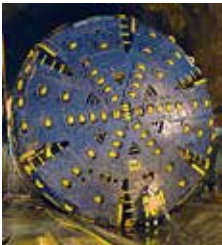
Det roterande kutterförsedda borrhuvudet trycktes mot berget och spräckte loss bergväggen.
