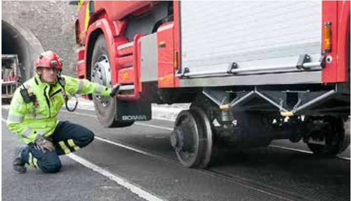
Räddningstjänstens spårbundna släckfordon som finns på stationerna i varsin ände av tunneln.
