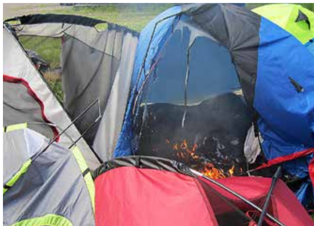
På räddningstjänstens övningsfält gjordes fyra mindre försök för att testa risken för brandspridning vid brand i tält.
