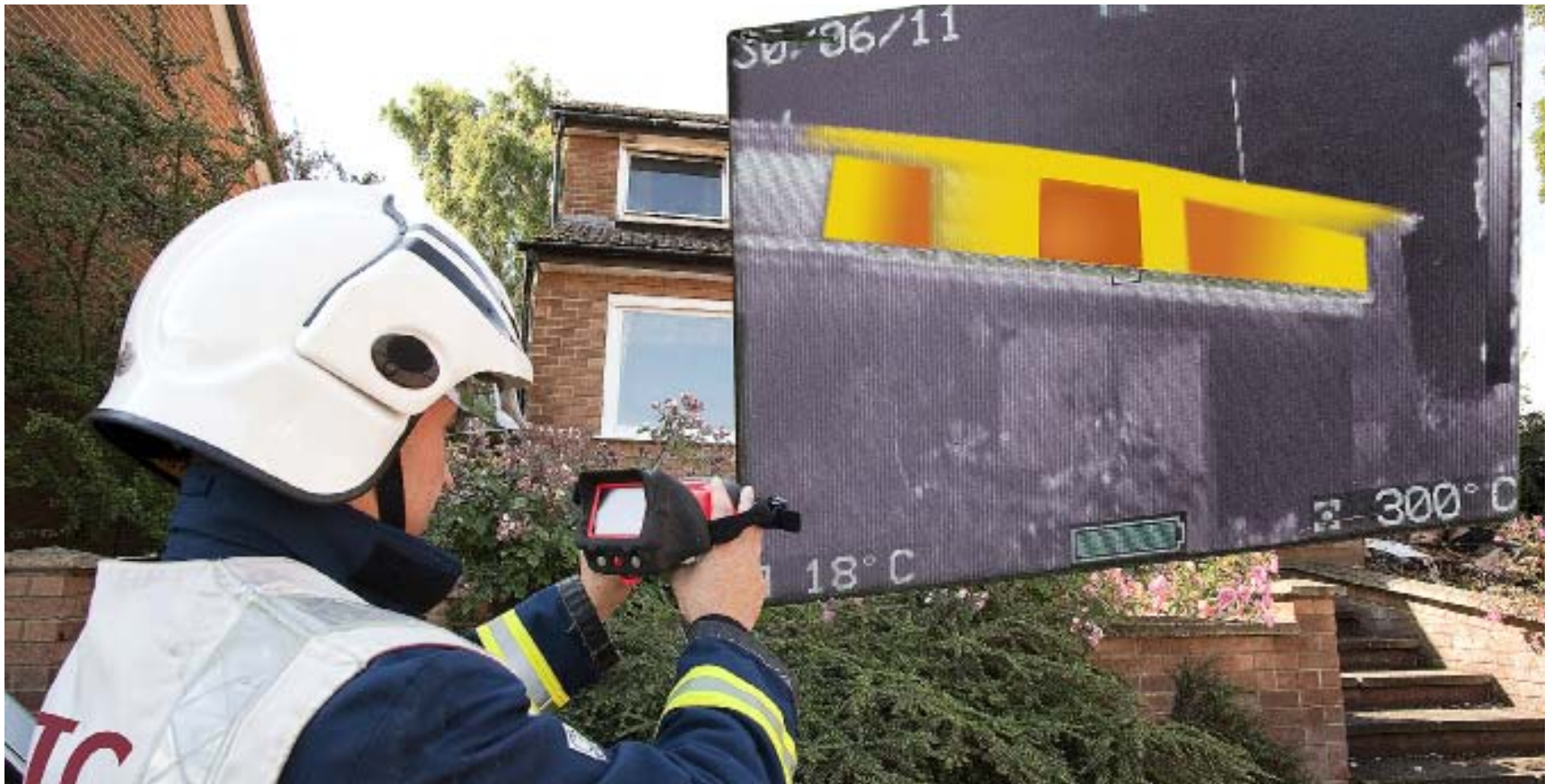
I kamerabilden, som ses infäld i bilden, kan insatsledaren läsa av branden utifrån. I det här fallet är det uppenbart att de heta zonerna är på övervåningen. FOTO: BO NYSTRAND
