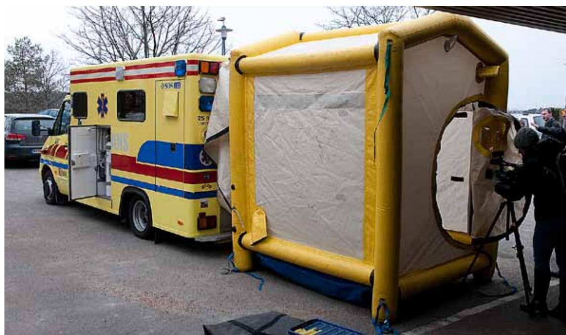
För byte och sanering av vårdpersonal under transporten kopplas en luftsluss till ambulansen inne i Herculesplanet. En fläkt med avancerad luftrenare skapar undertryck i tältet och hindrar att kontaminerad luft läcker ut.
