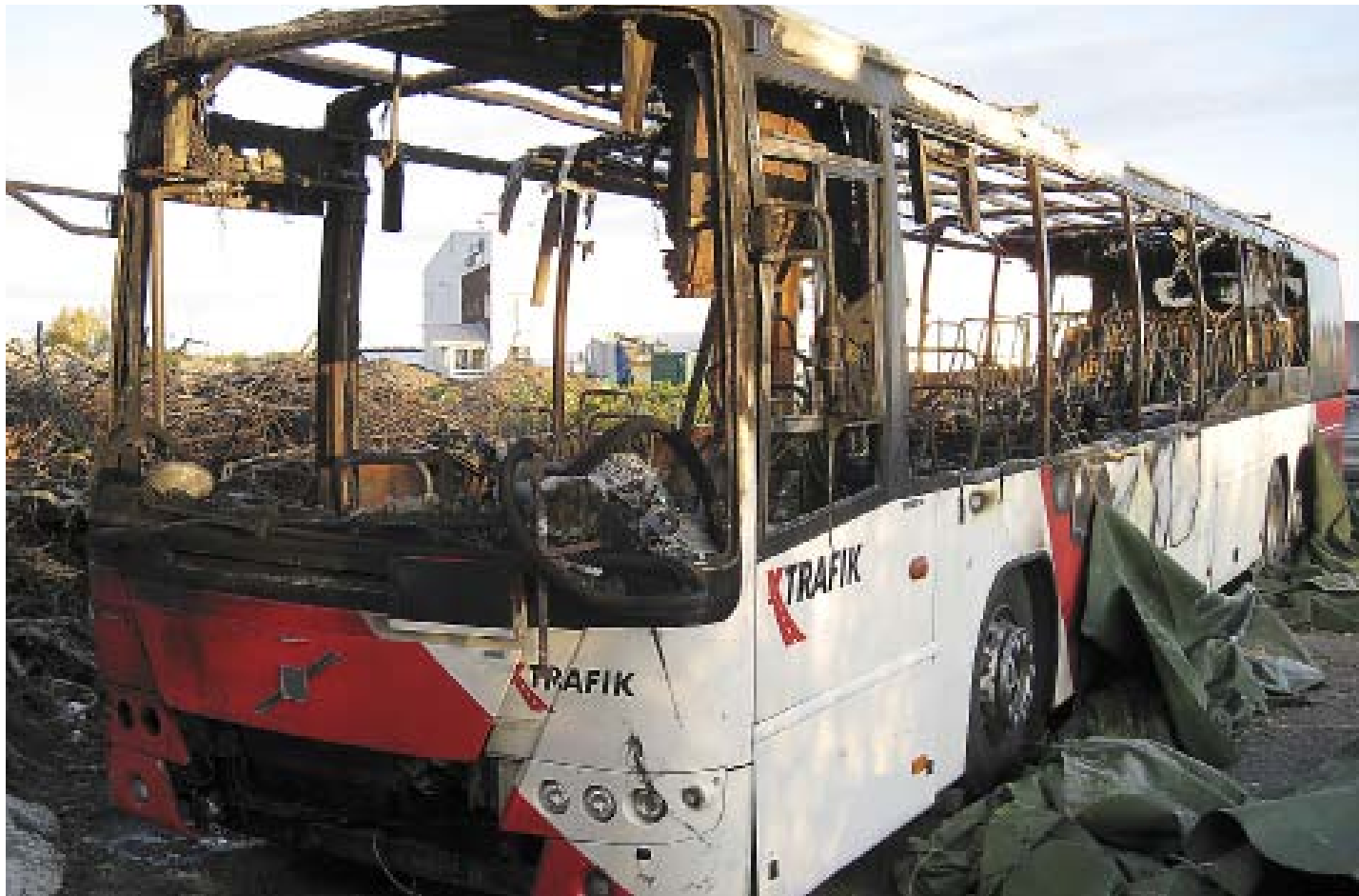
Totalt utbränd buss. Skav mot plåtkant skapade kortslutning mellan plus och minus kablar på inbyggd 220 volts batteriladdare och orsakade branden.
