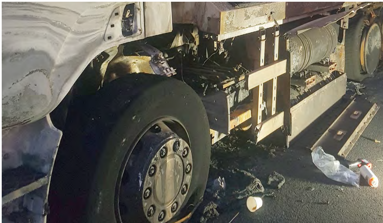
En gasdriven sopbil fattade eld i ett bostadsområde. Innan insatsstyrkan hunnit fram till platsen hade brandspridning skett till hela fordonet. Två däckexplosioner inträffade och strålningsvärmens från branden var så intensiv att en intilliggande villa hotades av brandspridning.
