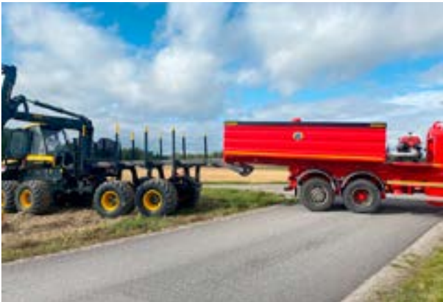
Den specialutvecklade lastrampen har lyfts på skotaren med hjälp av skogsmaskinens kran. FOTO: PRIVAT
