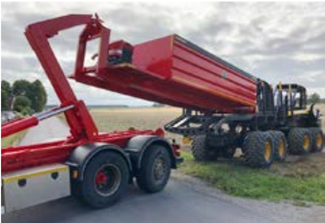
Lastväxlarflaket skjuts över från brandbilen till skotaren med brandbilens lastväxlersystem. FOTO: PRIVAT
