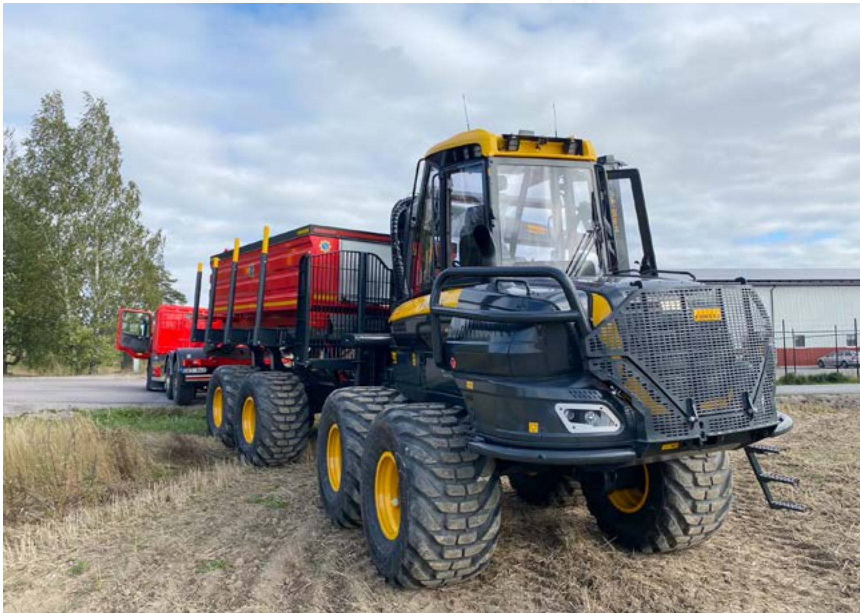
Få en terränggående brandbil genom att kombinera befintlig utrustning från en brandbil och en skotare.
